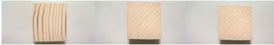
Fig. 3 - Debitarea materialului lemnos perpendicular pe fibra lemnului, fibra având un rol estetic prin jocul de nuanțe și direcție
