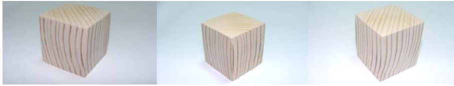
Fig. 2 - Debitarea materialului lemnos perpendicular pe fibră, laturile cubului reliefând dispunerea fibrei lemnoase în mod diferit pe fețele cubului
