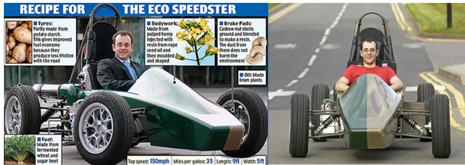
Fig. 1 - Concept vehicul ecologic realizat în proporție de 95% din materiale biodegradabile (2)
