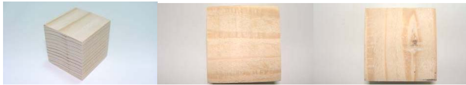
Fig. 4 - Debitarea materialului lemnos longitudinal în raport cu fibra lemnului. Fibra prezintă un rol estetic prin jocul de nuanțe, direcție sau a unor defecte prezente în structura lemnoasă (noduri)
