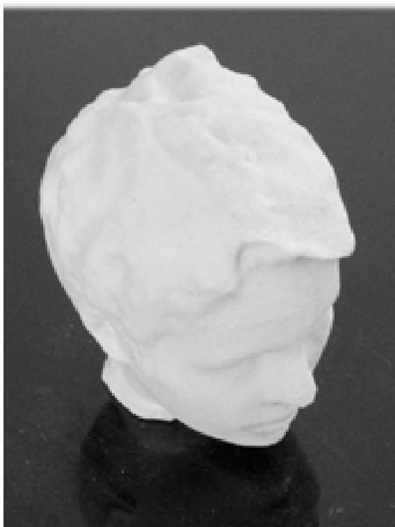
Fig. 3 - Obiect realizat cu ajutorul printerului 3D – Zprinter 310 Plus, din pulbere ZP 131, la care aplicarea stratului întăritor din silicat de sodiu, soluție 50%, s-a realizat cu ajutorul pensulei
